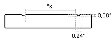
\*Dimension variable en fonction de la largeur de la porte / Variable dimension depending on door width
